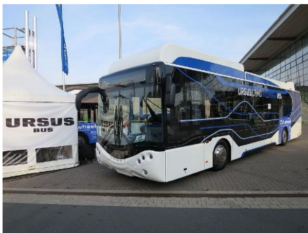
Rys. 2.4 Autobus elektryczny z wodorowymi ogniwami paliwowymi
