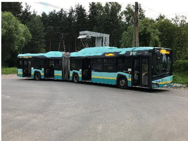
Rys. 4.2 Autobus elektryczny akumulatorowy typu MAXI w Jaworznie podczas szybkiego ładowania Źródło: Zbiory własne
