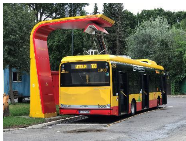
Rys. 4.4 Ładowanie autobusu elektrycznego akumulatorowego z ładowarki pantografowej w Warszawie
