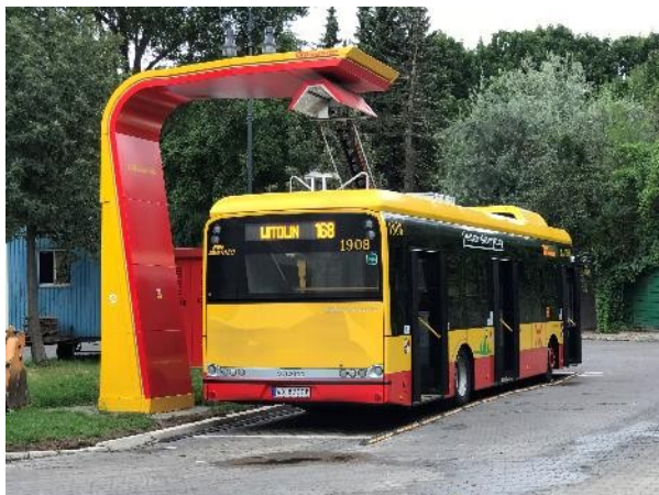
Rys. 4.3 Ładowarka pantografowa i autobus elektryczny akumulatorowy Solaris Urbino 12 electric w malowaniu ZTM Warszawa
