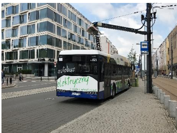
Rys. 2.4 Autobus elektryczny akumulatorowy na stacji szybkiego ładowania w Krakowie
